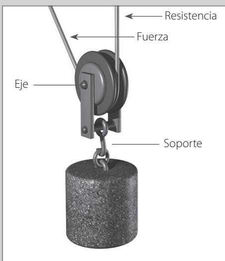
La polea fija es un eje de rotación que se encuentra fijo. El siguiente esquema representa una polea fija.
