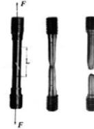
*Muestra típica de sección circular para el ensayo de tensión - deformación*
