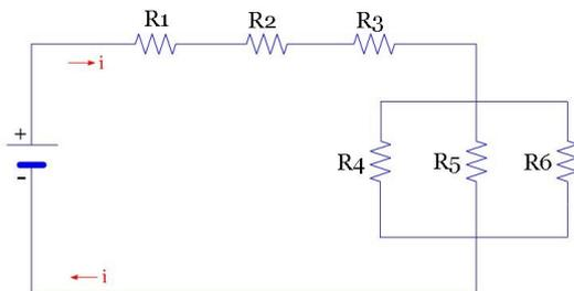
La fuente de fem conserva un terminal positivo (barra larga y delgada), y el otro terminal negativo (barra corta y gruesa). Las resistencias se pueden combinar de dos maneras, en serie y en paralelo. En la figura se muestra una fuente de fem a la cual van conectadas tres resistencias en serie ( $R_1$ ,  $R_2$ ,  $R_3$ ) y tres resistencias en paralelo ( $R_4$ ,  $R_5$ ,  $R_6$ ):
