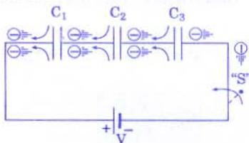
Cuando el interruptor S se cierra a la placa colectora de  $C_3$  se le transfiere electrones ocasionando por inducción, expulsión de electrones de la placa condensadora; y análogamente ocurre con  $C_2$  y  $C_1$ , quedando electrizados todos los capacitores.
