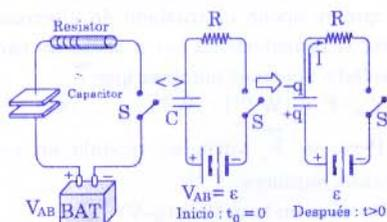
Inicialmente el capacitor está descargado y no hay flujo de electrones ( $I=0$ ) cuando el interruptor S está abierto.
