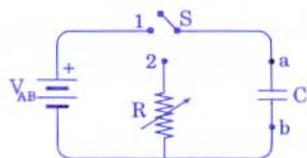
R: potenciómetro de descarga
