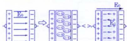
Debido al campo eléctrico externo de intensidad  $\vec{E}_0$ , las moléculas del dieléctrico se alinean; entonces decimos que el dieléctrico se polariza y en consecuencia se induce un campo eléctrico de intensidad  $\vec{E}_1$ ; por lo tanto, la intensidad del campo eléctrico resultante dentro del capacitor es
