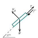
b) Para hallar el valor del coeficiente de rozamiento, descomponemos las fuerzas del peso en dirección paralela y perpendicular al plano:
